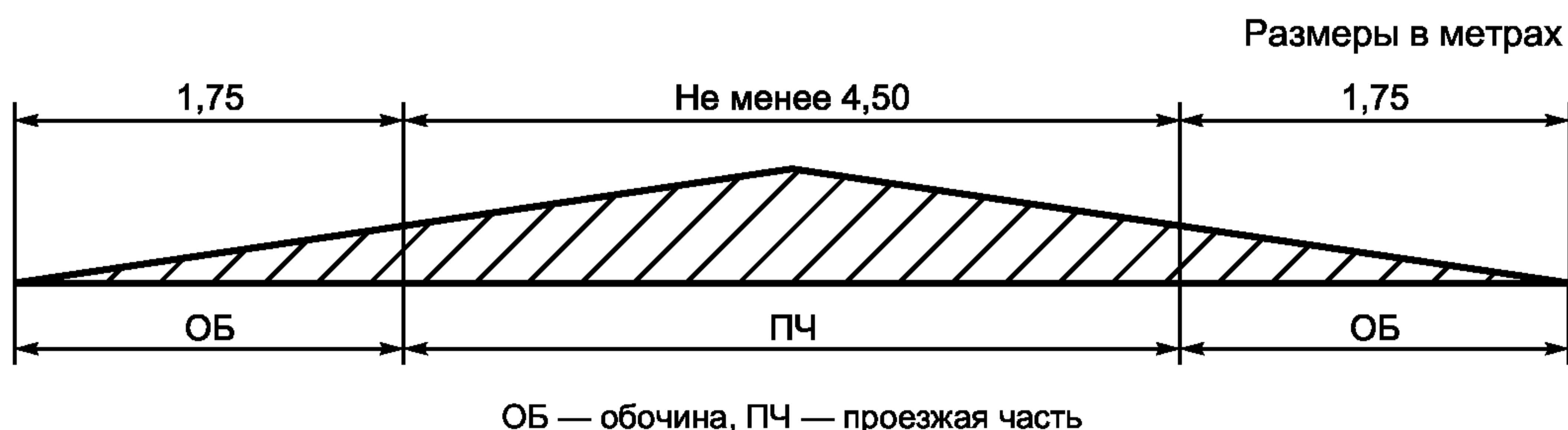
Рисунок 12 — Поперечные профили автомобильных дорог категории V
